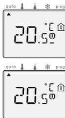
ratur schwankt; ein Temperaturwechsel im Raum kann das automatische Erkennen „Fenster offen“ auslösen.
