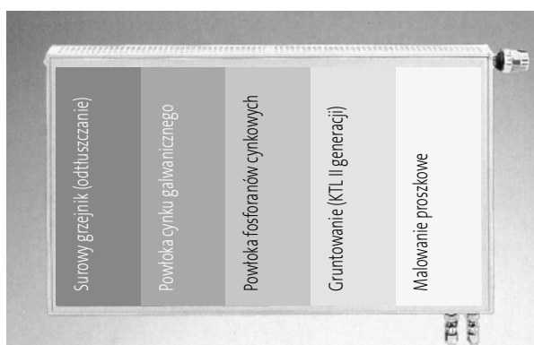
Przygotowanie powierzchni grzejnika
